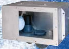
**Skimmer en inox - Modèle 1.** Fabriqué en acier inoxydable AISI 304. Ø 50 mm de débordement. Largeur d'écrémage: 190 mm, profondeur d'installation: 240 mm. Aspiration: Ø 63 mm PVC. Option installation d'un flotteur pour la régularisation du niveau d'eau. Prise de terre est incluse. Complet avec panier skimmer 04111SS01 et un couvercle à hauteur réglable 04111SS02.
