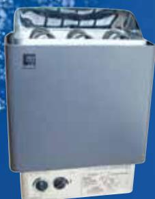
**Poêle pour saunas avec commande intégrée.** En acier inoxydable. Séries SCASS. Dimensions 43 x 30 x 60 cm. Compartiment à pierres: 7,5 kg.
