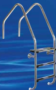
**MODÈLE 304 ASYMÉTRIQUE AVEC MARCHES EN ACIER INOXYDABLE - POUR PISCINES PUBLIQUES.** Largeur 500 mm. Marches antidérapantes en acier inoxydable de qualité AISI 304. Sorties de bain en acier inoxydable de qualité AISI 316 poli Ø 42 mm. Complet avec ancrages plastiques, enjoliveurs, capuchons, boulons et écrous et une marche de sécurité double conformément à la norme EN 13451-2/AC.
