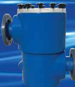
Préfiltre en polyester renforcé en fibre de verre. Raccord à bride coulissante, capacité 65 l. Les raccords des tuyaux peuvent être fabriqués sur demande. Panier en acier inoxydable. Couvercle transparent acrylique. Peut être utilisé avec les raccords jusqu'à 250 mm.
