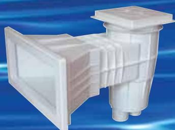
Tous les modèles Lux sont fabriqués en ABS et équipés d'un clapet débit. Écrémage par "bouée flottante" ou "volet flottant". Aspiration: Première sortie: fileté femelle 2" Deuxième sortie: fileté femelle de 1 1/2" aveugle. Trop plein: femelle à coller Ø 40 mm. Complet avec bride, joints, vis en acier inoxydable et cache vise avant. Insert plastique ou laiton.
