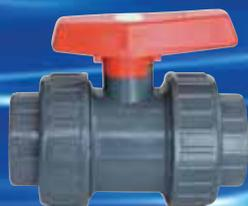
**Vannes à boisseau en PVC.** Raccord à coller, anti bloque. Le serrage des unions grâce à la poignée breveté. Sièges en PEHD et joints toriques en EPDM. PN 16.
