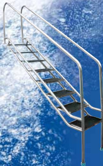
**ÉCHELLE EN INOX (MODÈLE INCLINÉ 304) - LARGEUR=500 mm.** Facilité d'entrée et de sortie des piscines de détente ou hydrothérapeutiques. Ne nécessite pas d'utiliser un siège élévateur hydraulique. Sorties de bain en acier inoxydable de qualité AISI 316 poli Ø 42 mm, avec une surface antidérapante en polyester sur les marches, ancrages plastiques, enjoliveurs, capuchons, boulons et écrous.
