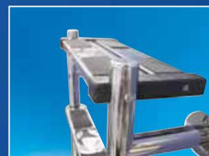
**MODÈLE SPLIT 304 AVEC MARCHES EN ACIER INOXYDABLE - POUR PISCINES PUBLIQUES.** Largeur 500 mm. Marches antidérapantes en acier inoxydable AISI 304. Sorties de bain en acier inoxydable de qualité AISI 316 poli Ø 42 mm, avec ancrages plastiques, enjoliveurs, capuchons, boulons, écrous et une marche de sécurité double conformément à la norme EN 13451-2/AC.
