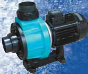
**GEMAS FLOODER JET.** Pompe pour jet au corps thermoplastique. Aspiration et Refoulement 4" (Ø110). Raccords unions à coller. Moteur IP 55 de 2850 rpm.
