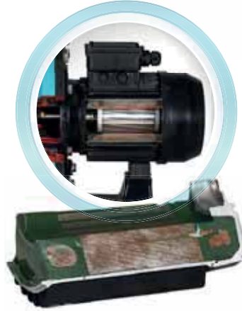
izolasyonlu motor sarğı kesiti Stator kesiti
