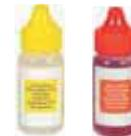
**TOTAL HARDNESS TEST KIT.** By titration method.
